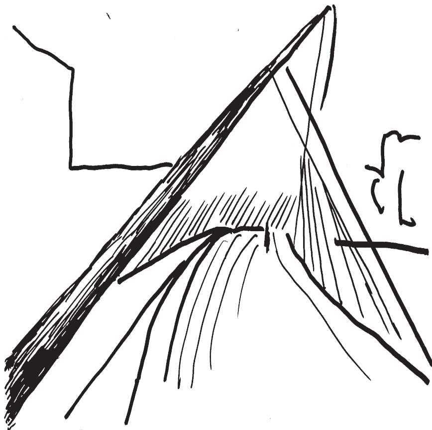
Rys. 17. Kładkę dla pieszych Santiago Calatravy, Campo Volatin w Bilbao zrealizowano w konstrukcji żelbetowej. Zastosowano wieszaki stalowe.
