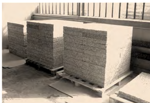
Rys. 52. Przykładowe zastosowania nowej technologii IZOPETU-R, jako warstwy drenażowej i ochronnej. Składowanie płyt IZOPETU-R.
